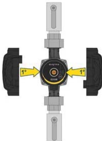
Obrázek 7: Izolace tělesa čerpadla
