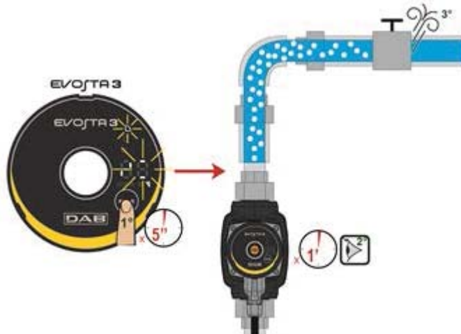
Obrázek 9: Automatické odvzdušnění čerpadla
